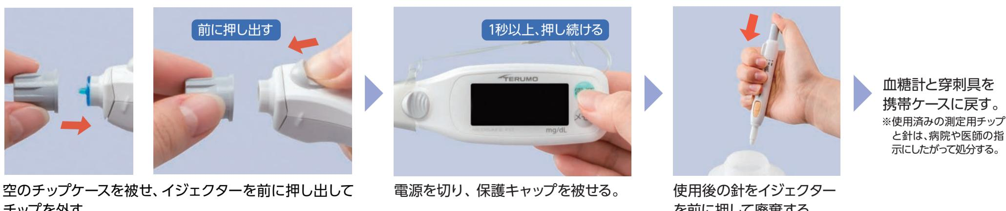
空のチップケースを被せ、イジェクターを前に押し出してチップを外す。
