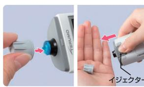
空のチップケースをかぶせ、裏面にある イジェクターを前に押し出してチップをはずす。
